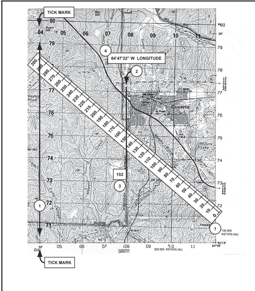
Figure 4-5. Determining longitude
